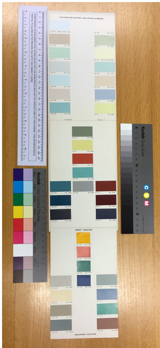
図3 「機械の色彩,安全色, パイプ識別のための色彩」カラーチャート 上が工場,オフィス室内色, 下が安全色と機械の色
