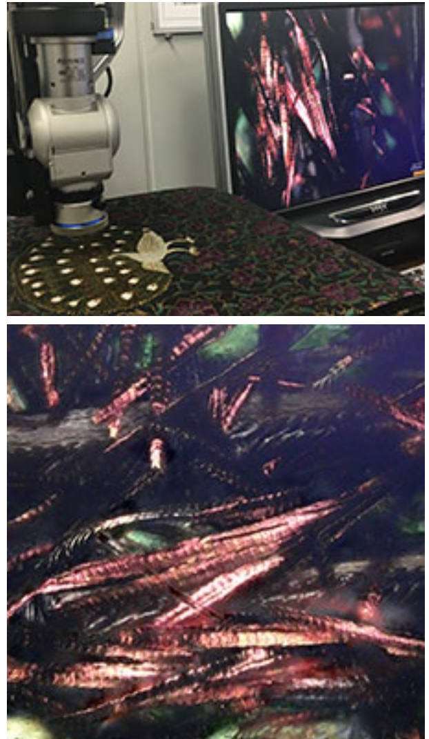
図3. 顕微鏡による「孔雀羽根織」丸帯 (試料C) の孔雀羽根織部観察 上: 観察風景 下: 拡大像
