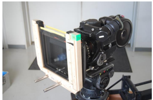
写真4, カメラに装着した 1inch 水フィルター
